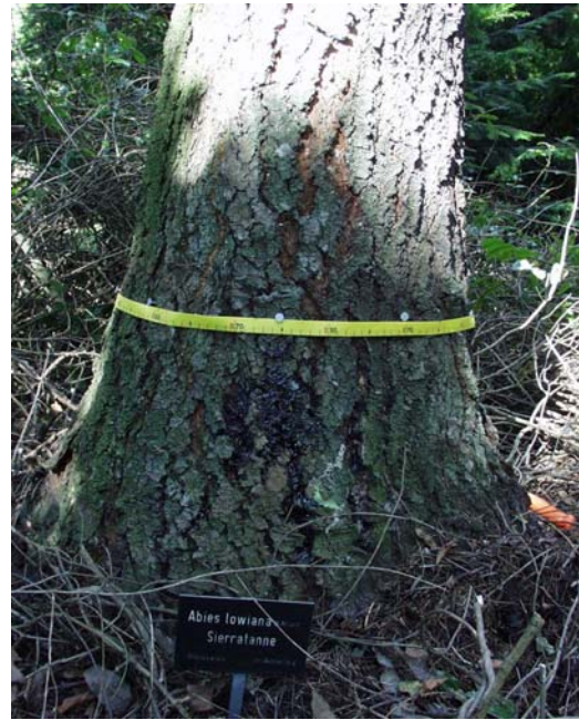
Abbildung 10: Messebene mit Nägeln für die Sensoren
