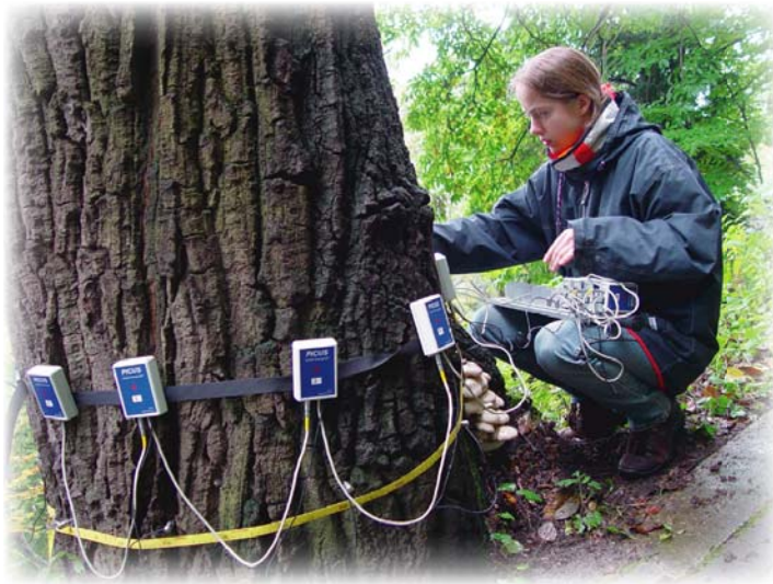
Abbildung 2: Anbringen der Sensoren für die Schallmessung
